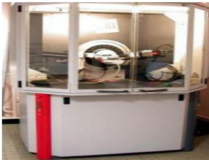
*Figure II.2 : Image d'un diffractomètre (DRX) Bruker D8 Advance.*
