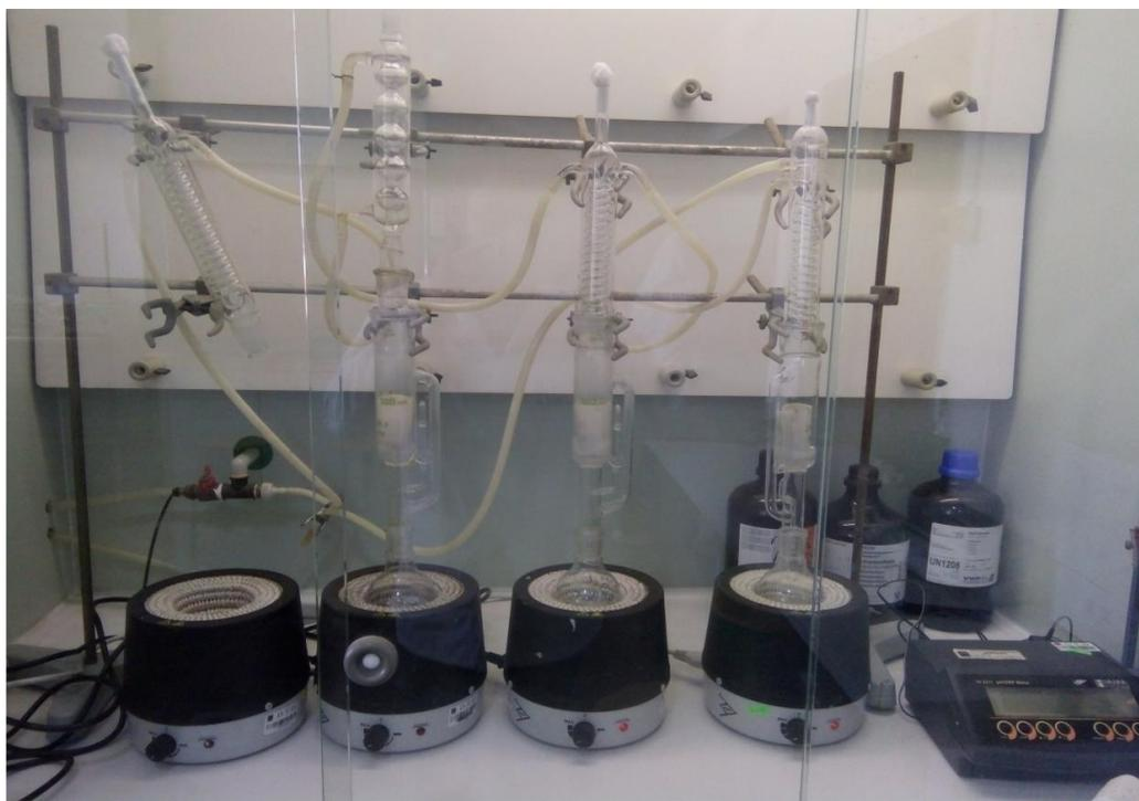
**Figure III.14:** Extraction par soxhlet.
