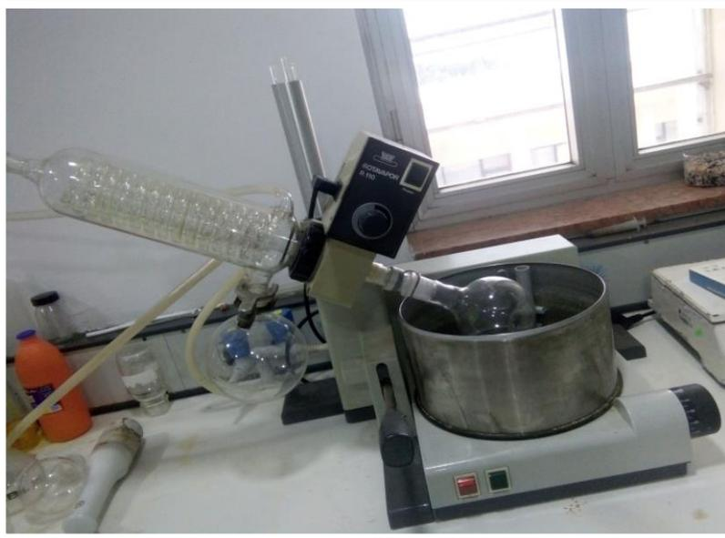
**Figure III.6:** Montage de rotavapor.
