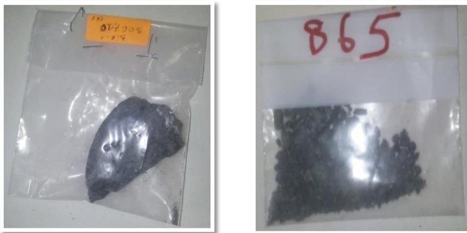
**Figure III.11 :** Echantillons de carottes et de cuttings.
