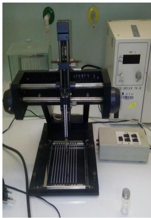
**Figure III.20:** Déposeur d'échantillon automatique et semi-automatique.
