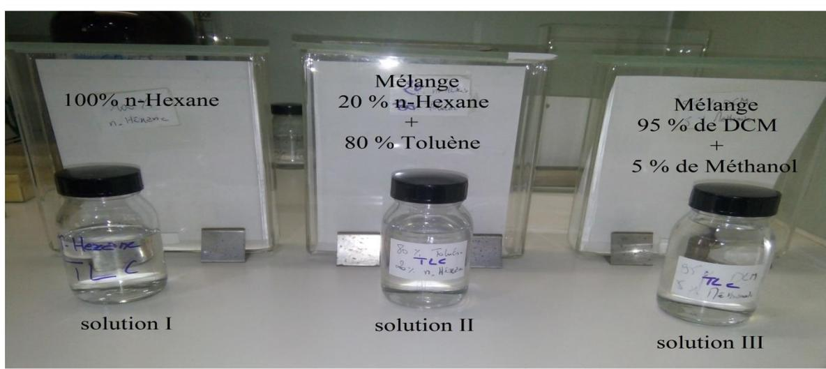
**Figure III.19:** Les solvants et les cuve d'élution.
