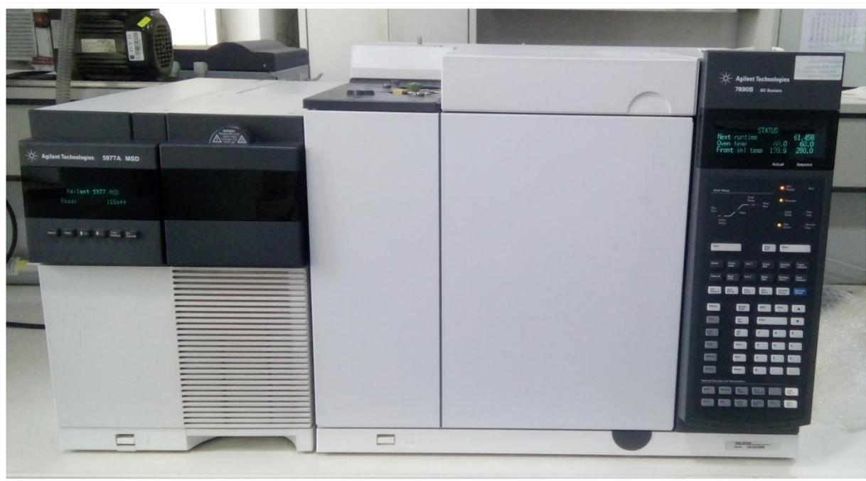
**Figure III.26:** Appareil GC /MS, chromatographie en phase gazeuse couplée à la spectrométrie de masse.
