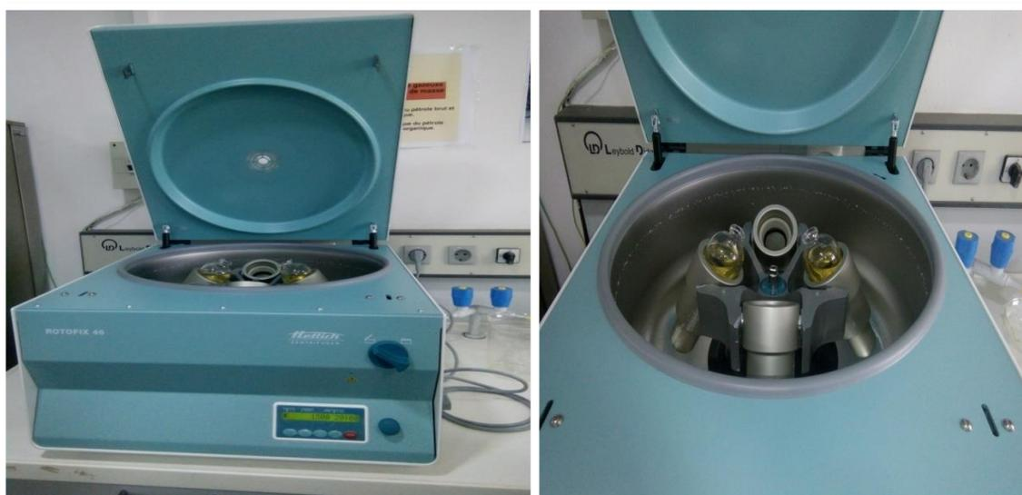
**Figure III.16:** Elimination des asphaltènes par di-asphaltage à l'aide d'une centrifugeuse (ROTOFOX 7).
