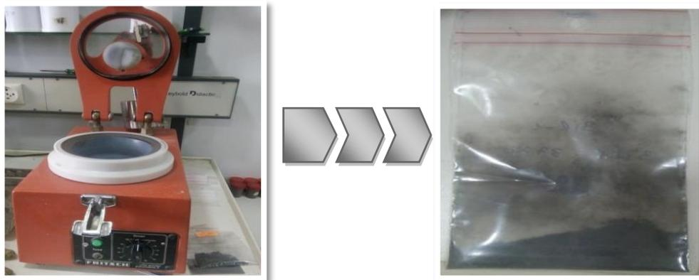
**Figure III.12 :** Broyage d'échantillons par un broyeur (FRITSCH).
