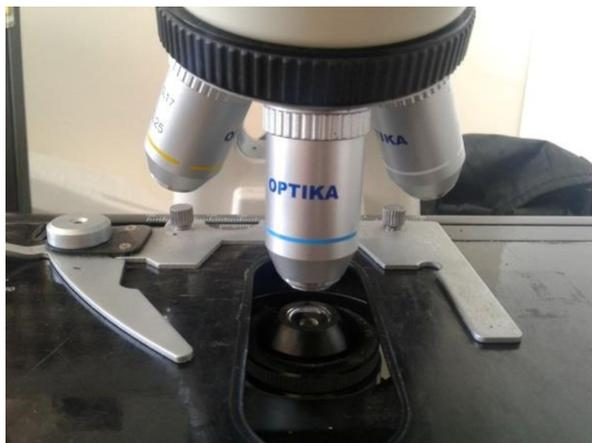
**Figure II.12 : Objectif du microscope optique OPTIKA.**
