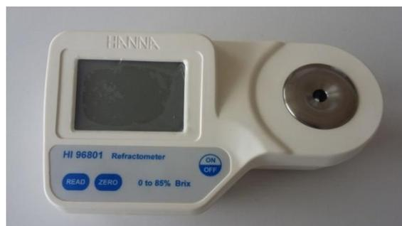
Figure II.1 : Refractomètre numérique Hanna HI 96801.
