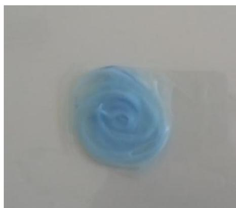
**Figure III.1 : Résultat du test au bleu de méthylène.**
