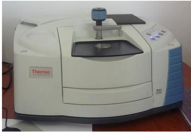
**Figure II.3 : Spectromètre FTIR/ATR Thermo Scientific Nicolet iS 10.**
