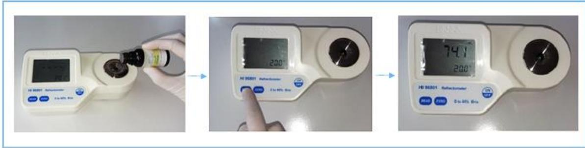
**Figure II.9 : Méthode d'utilisation du refractomètre numérique HANNA HI 96801.**
