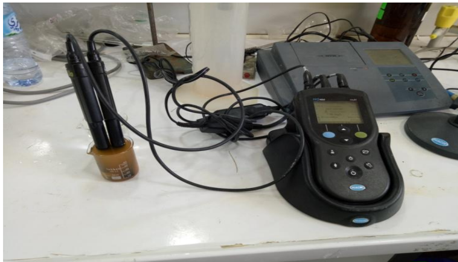
Fig. 2 : dispositif de mesure de la conductivité et l'oxygène dissous.
