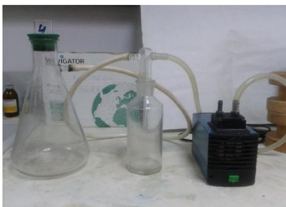
Figure 1 Dispositif de Filtration sous vide
