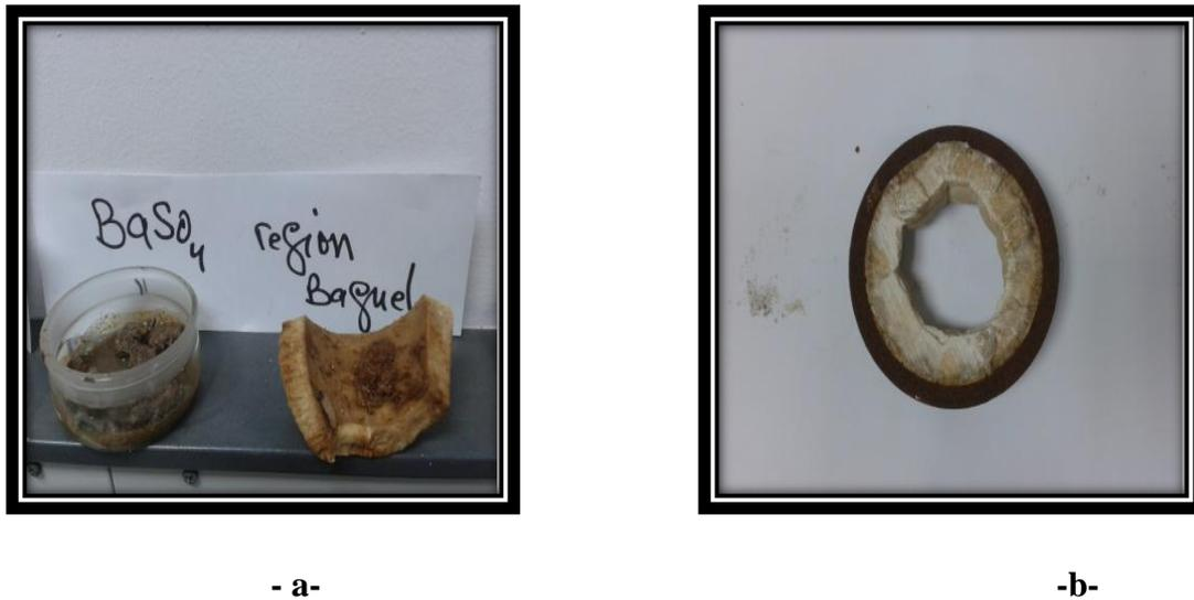
**Figure I.5** Les dépôts de sulfates ((a) BaSO<sub>4</sub> Region Baguel, (b) BaSO<sub>4</sub> Region TFT).
