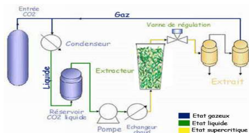
Figure I.13 : Extraction au CO 2 supercritique.
