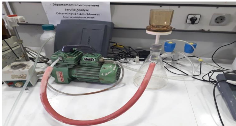
Figure II-20 : Pompe de filtration sous vide.
