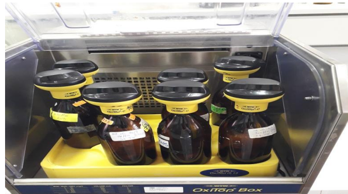
Figure II-22: Mesure de la \text{DBO}_5 avec OxiTop.
