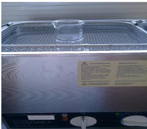
**Figure 03** : Nettoyage de la plaque de l'ITO dans un bain à ultrason.
