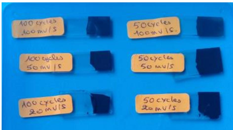
**Figure 12 :** Dépôts des films polymériques du PPy sur des plaques d'ITO.
