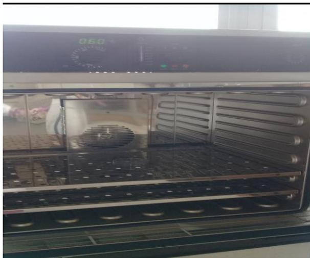
**Figure 04** : séchage de la plaque d'ITO.
