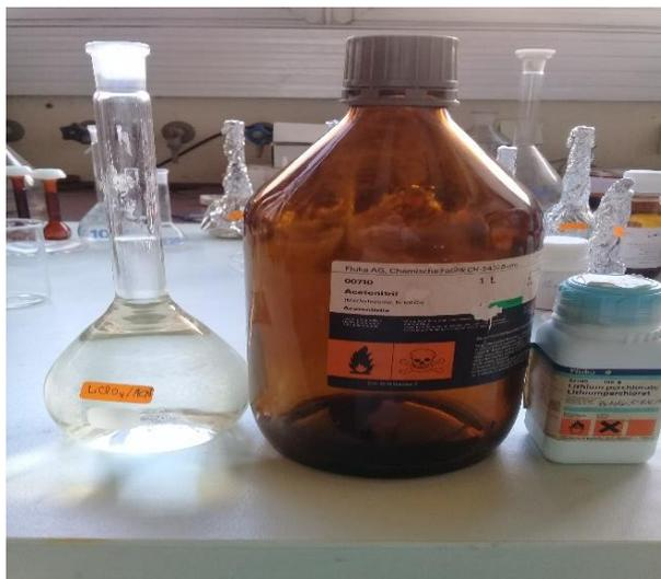
**Figure 01** : Produits utilisés pour la préparation de l'électrolyte organique.
