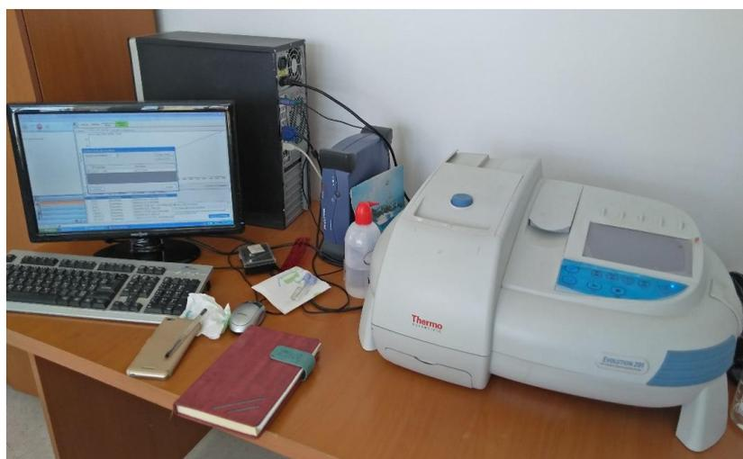
**Figure 11** : UV-Visible de type Evolution 201.
