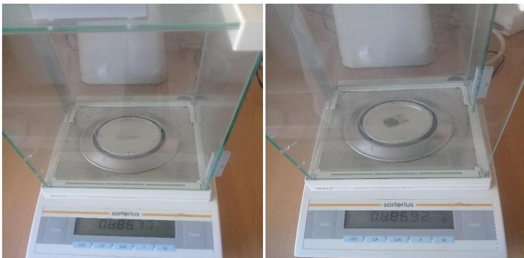
**Figure 07 :** a : Pesée de la plaque de l'ITO avant l'électropolymérisation ;
