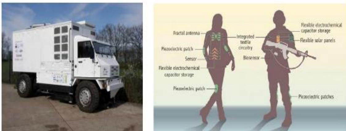
**Figure I.5 :** a) La plateforme ECCE, b) une représentation schématique de supercondensateurs intégrés aux vêtements et uniformes militaires [7].
