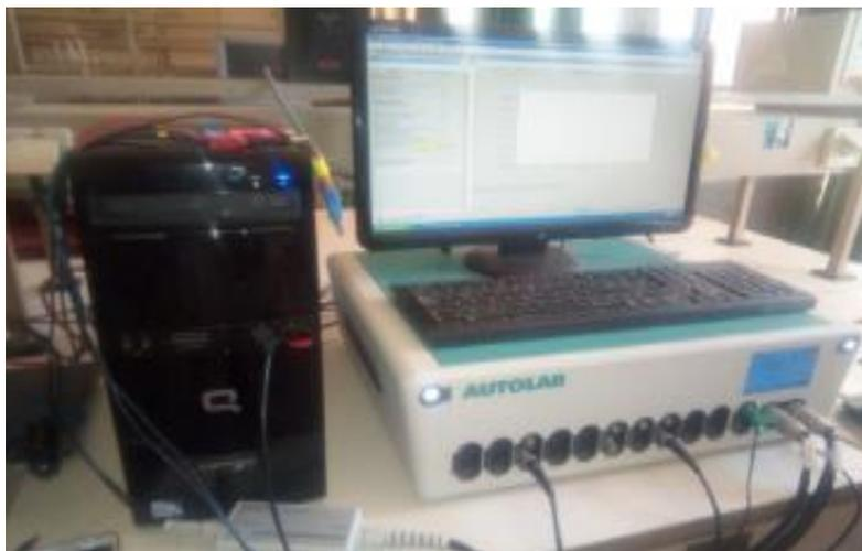
*Figure II.5 : Dispositif expérimental (station électrochimique type AUTOLAB 128N).*
