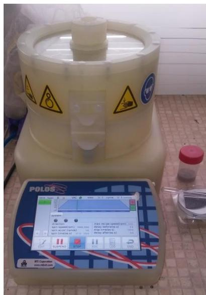
**Figure II. 9:** Photo de l'appareil de dépôt de 6H-SiC/PVA par spin coating.
