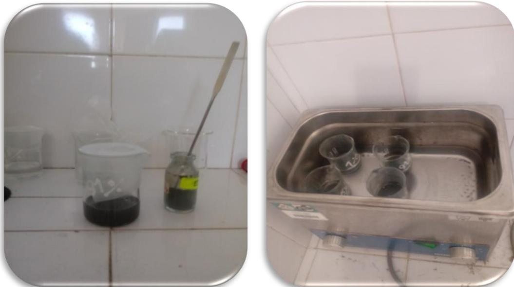
**Figure III. 10:** Préparation des mélanges matrice /nanoparticules de SiC.
