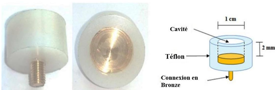
**Figure.IV.1.** Images de l'électrode à cavité en Téflon (ECT).
