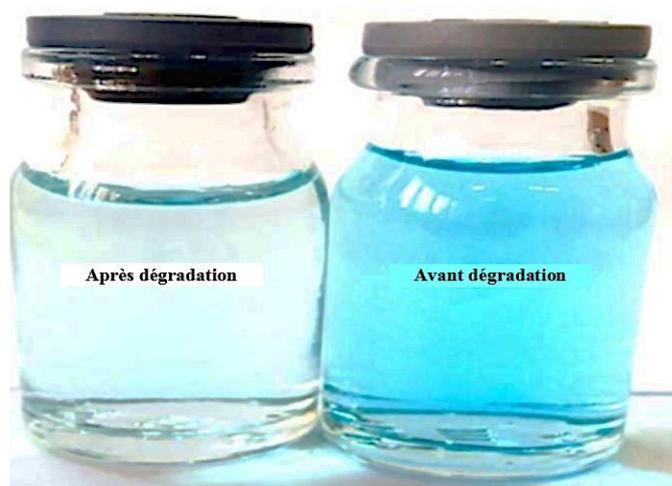
**Figure.IV.3.** Couleur de la solution de BM avant et après dégradation.
