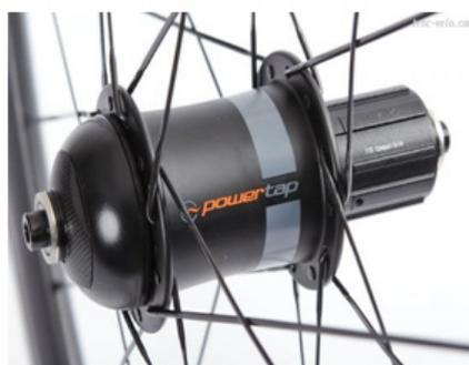
**Figure n° 02 : le capteur de puissance powertap G3 Hub**
