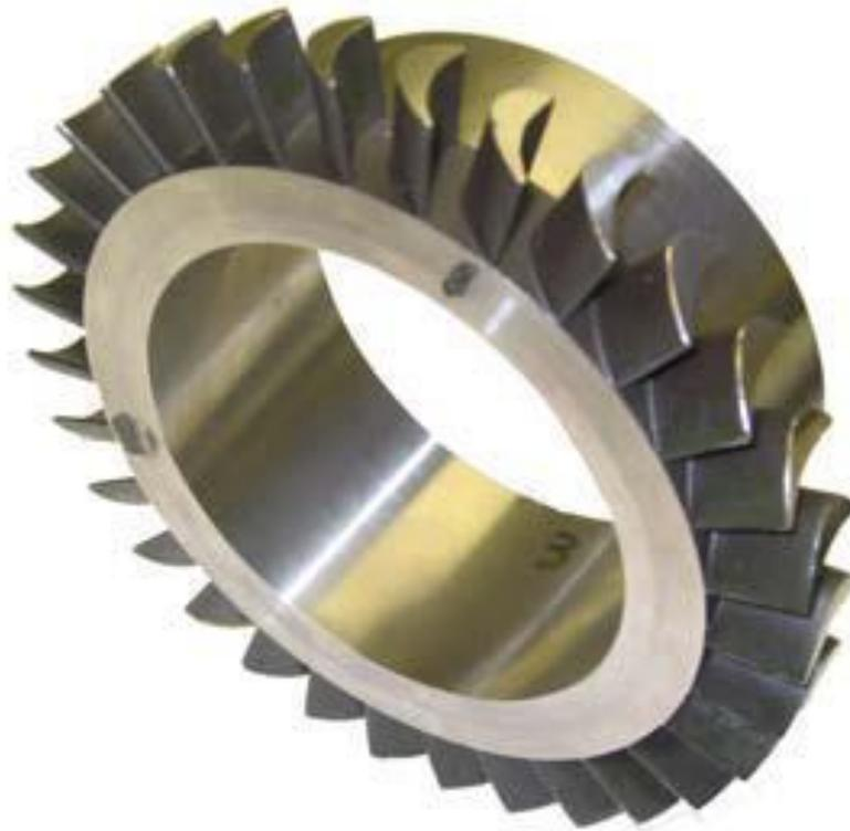
Figure 1.5 : Rotor d'un étage d'une turboforeuse
