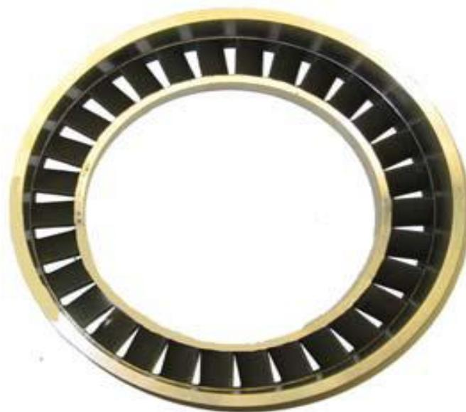
Figure 1.4: Stator d'un étage d'une turboforeuse
