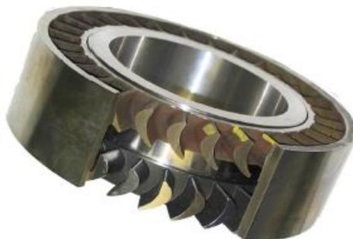
Figure 1.3: Image réelle d'un étage de turboforeuse
