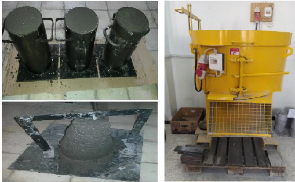
Figure III.1 : Préparation du béton et essais à l'état frais.
