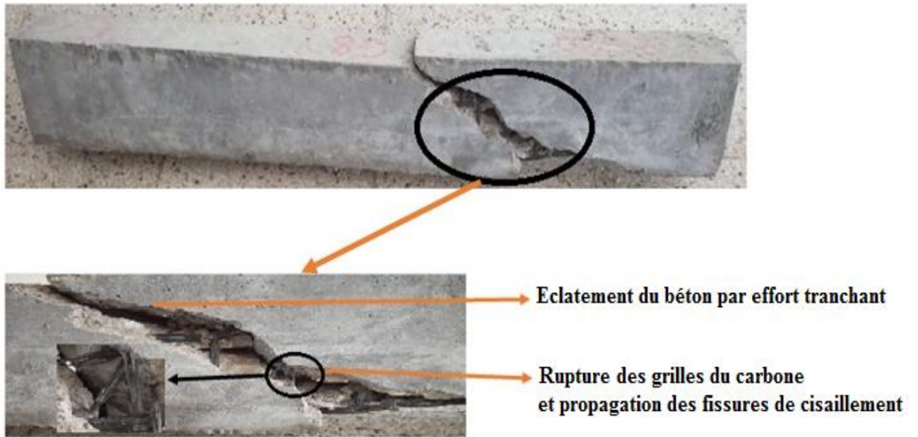
Figure IV.4 : Mode de rupture des poutres renforcées du groupe 03 (poutre CIEL (03)).
