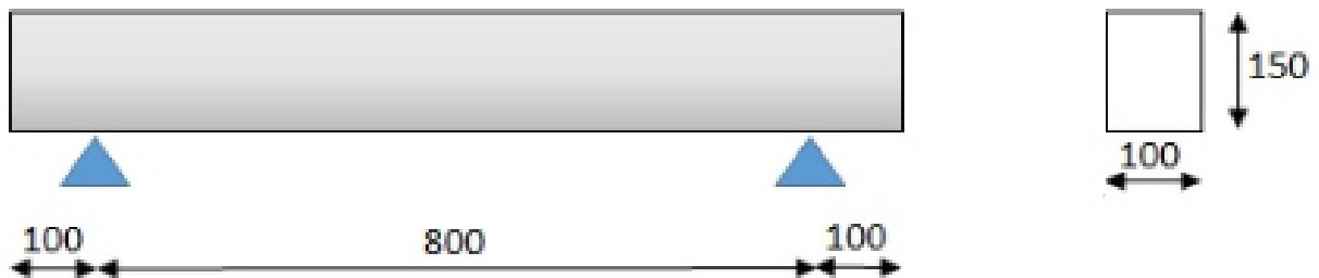
Figure III.10 : Dimensions des poutres testées.
