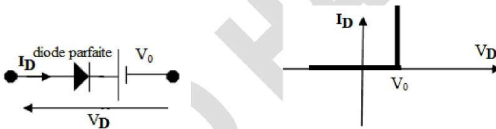
Figure 3.6 : Schéma équivalent et caractéristique d'une diode idéalisée
