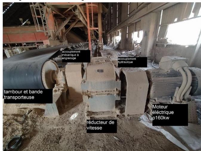
**Figure 1:** Illustration le positionnement de réducteur de vitesse dans processus de production
