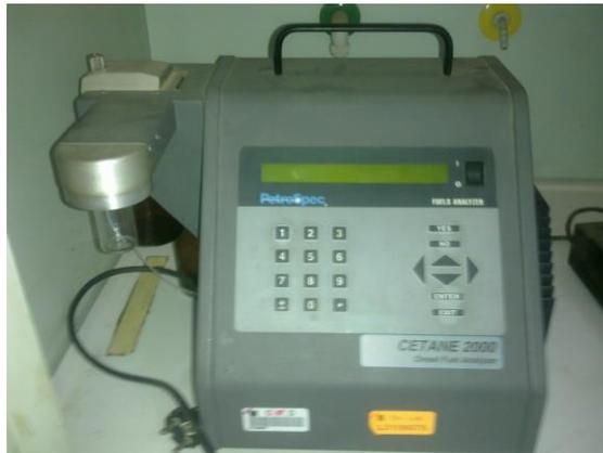
**Figure 2.11** Appareil de mesure de l'indice de cétane
