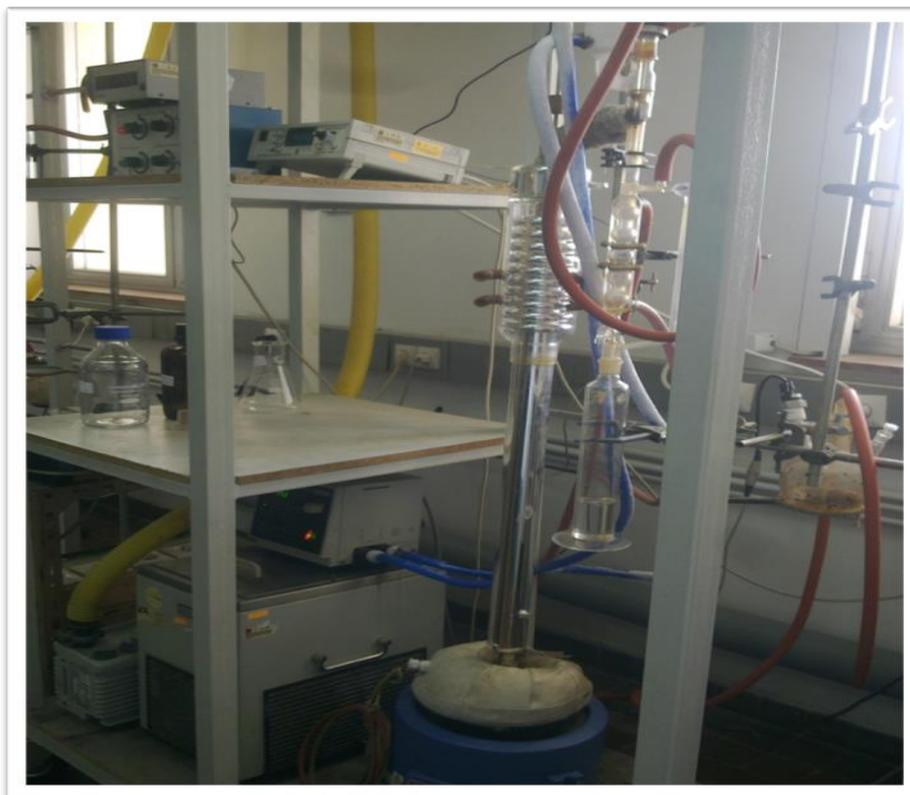
**Figure 2.13** : Dispositif de la distillation TBP
