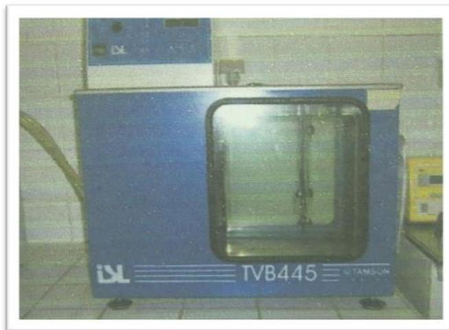
Figure 2.7 : Dispositif de mesure de la viscosité cinématique.
