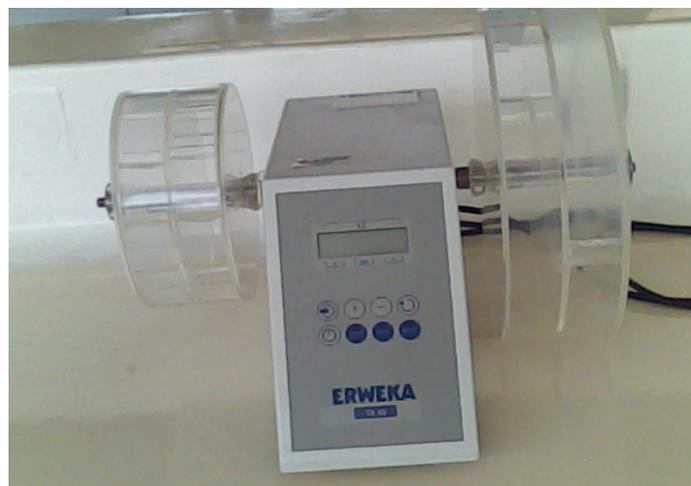
**Figure 7:** Photo d'un Friabilimètre de type (ERWEKA TA 40).
