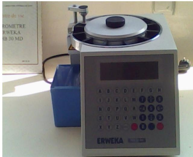
**Figure 8** : Photo du Duromètre (ERWEKA TBH 30 MD).
