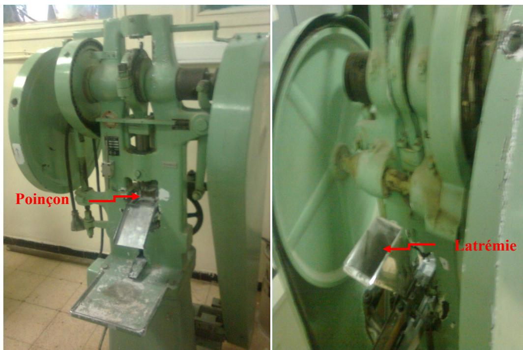
**Figure 6.** Photo de la compresseuse semi-automatique alternative de marque (ED. Frogerais, OA 307).
