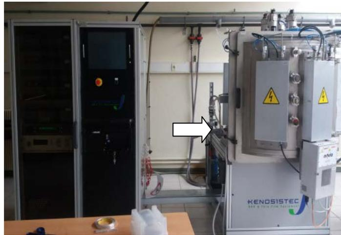
Figure II.5: Bâti de pulvérisation DC et RF.
