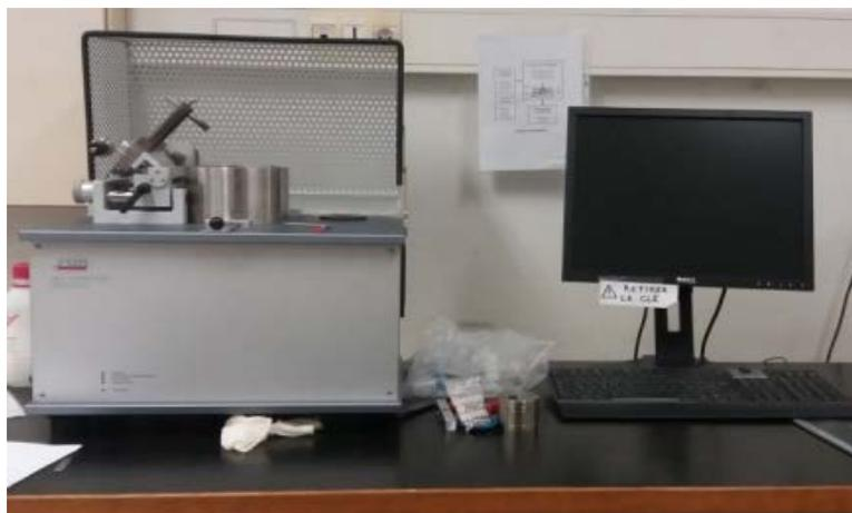
*Figure II.30: Tribomètre rotatif continu (TriboX-CSM Instruments du LaBoMaP de Cluny).*
