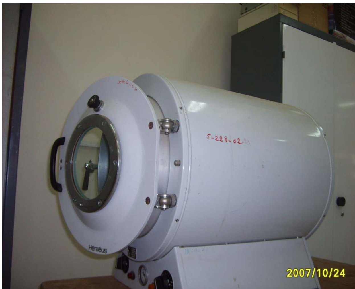
Photo V.8: Séchoir de laboratoire type Heraeus (Photothèque LRTA)
