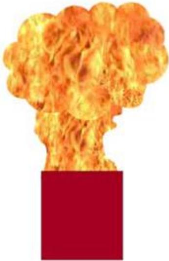
Une partie du liquide **déborde** du bac et une autre est **mise en suspension** en se fragmentant en gouttes et en se vaporisant en traversant les flammes pour former une **boule de feu** lors sa combustion.
