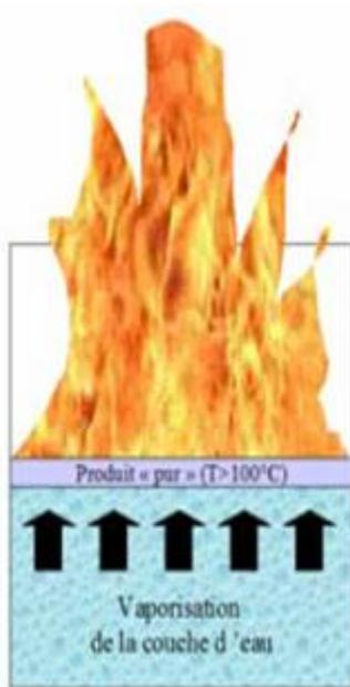
Une partie du liquide **déborde** du bac et une autre **mise en suspension** en se fragmentant en gouttes et en se vaporisant en traversant les flammes pour former une zone de combustion vive.
