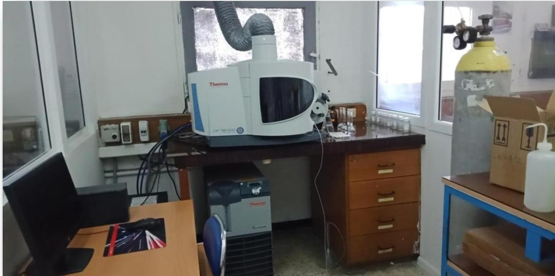
Figure 26 Appareil de l'ICP-OES.
