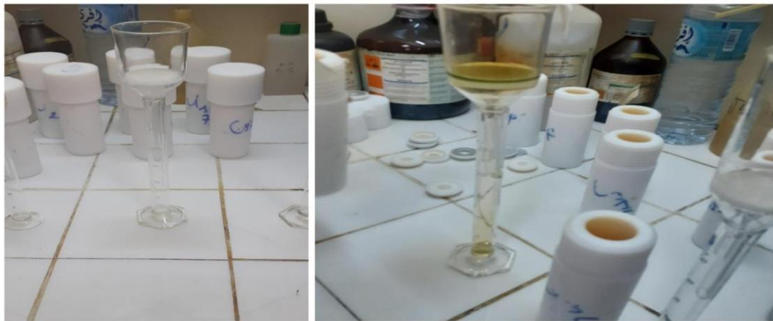
**Figure 23 Filtration des échantillons minéralisés.**
