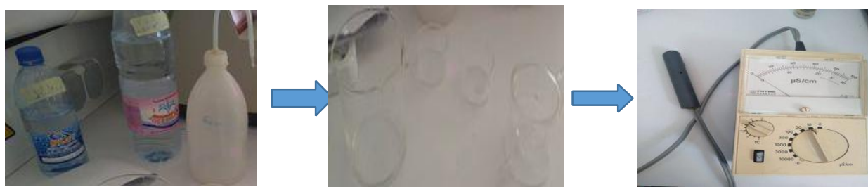
Figure III.2 : Les étapes de mesure la conductivité de l'eau
