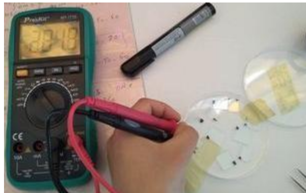
Figure III.1. Mesure de résistance de substrat ITO
