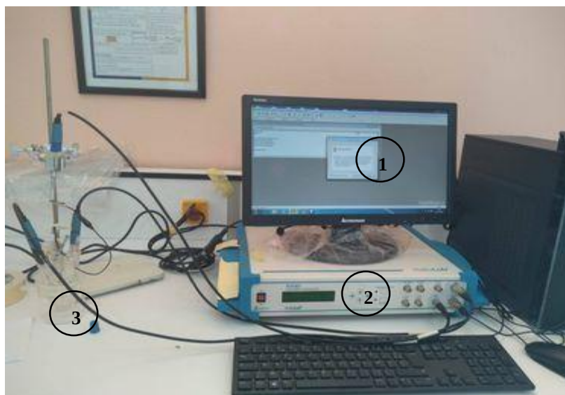
Figure III.5 : Dispositif expérimental de l'électrodéposition
