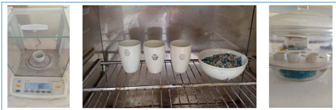
Figure II.1 : Protocole de mesure de la teneur en humidité.
