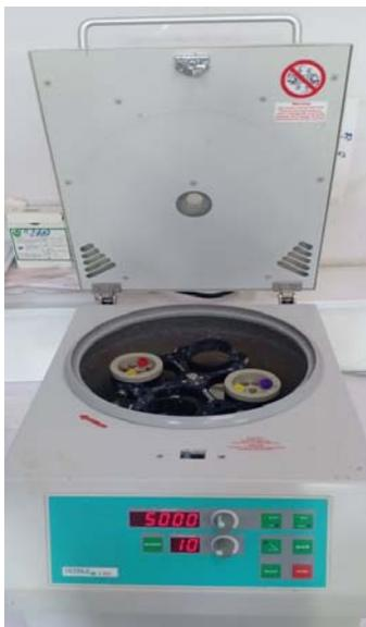
Figure II.7 : Centrifugeuse de la marque HERMLE.
