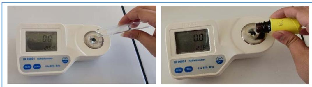
Figure II.4 : Mesure de l'indice de réfraction de l'HD et des HEs, respectivement.
