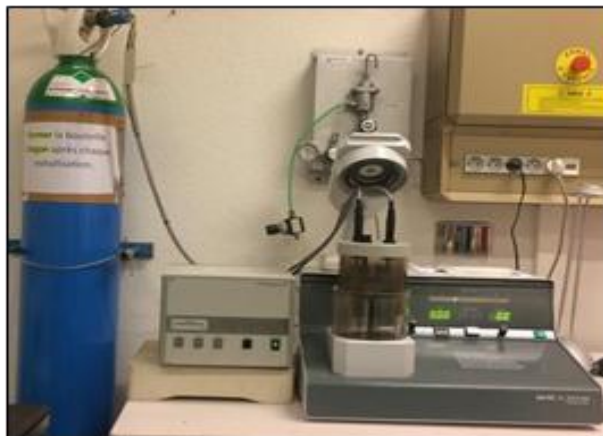
Figure IV.4 : Photographie de l'appareil de carbonisation
