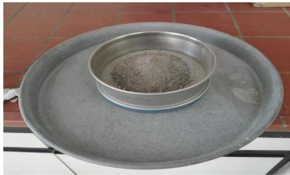
Figure 11 : Tamisage des échantillons
