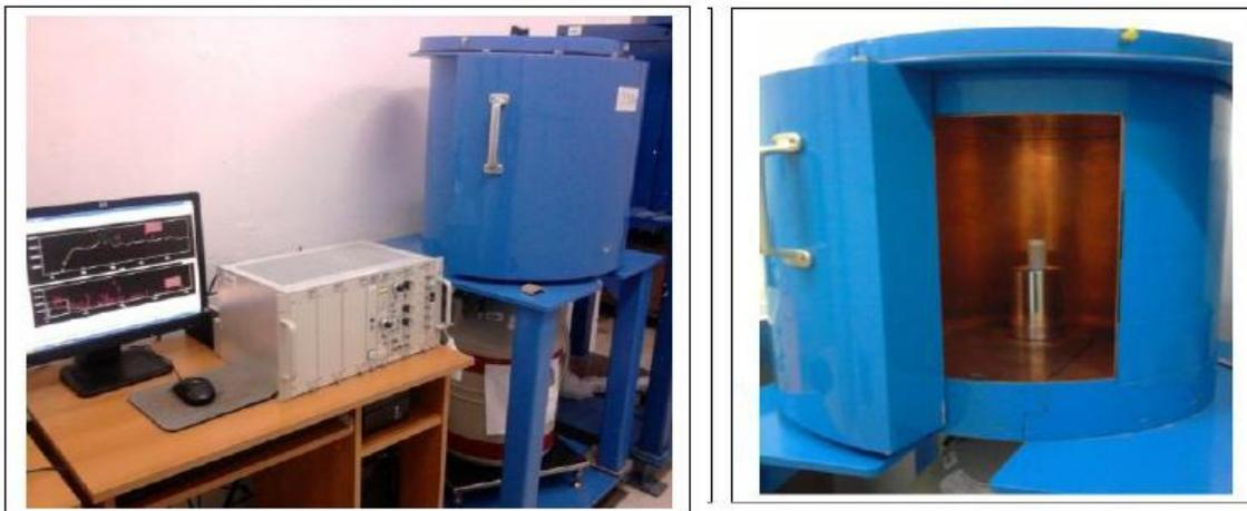
**Figure 22 : Chaîne de spectrométrie gamma**
