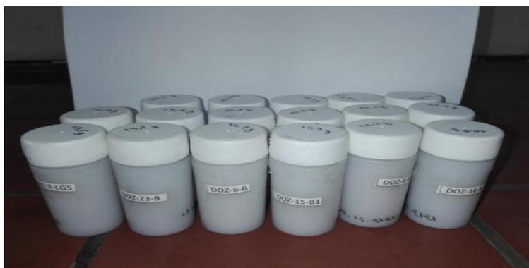
Figure 13 : Conditionnement des échantillons pour spectrométrie gamma
