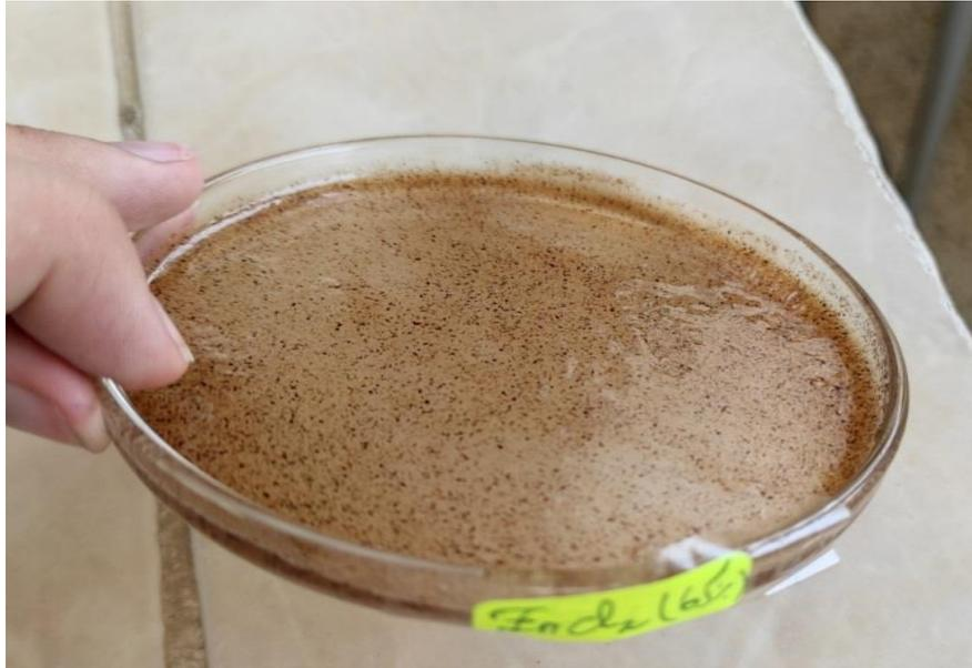
**Figure 14** : Solution obtenue après dissolution de la cellulose
