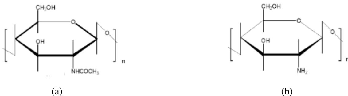
**Figure 5** : Structure de la chitine (a) et du chitosane (b)
