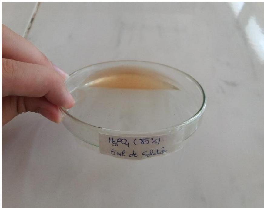
**Figure 12** : Solution obtenue après dissolution de la cellulose
