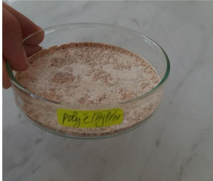
**Figure 21** : Biofilm à partir d'ester de cellulose avec plastifiant (polyéthylène glycol 4000)
