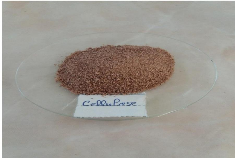
**Figure 10** : Cellulose obtenue après extraction des hémicelluloses.
