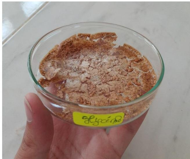
**Figure 22** : Biofilm à partir d'ester de cellulose avec plastifiant (glycérol)
