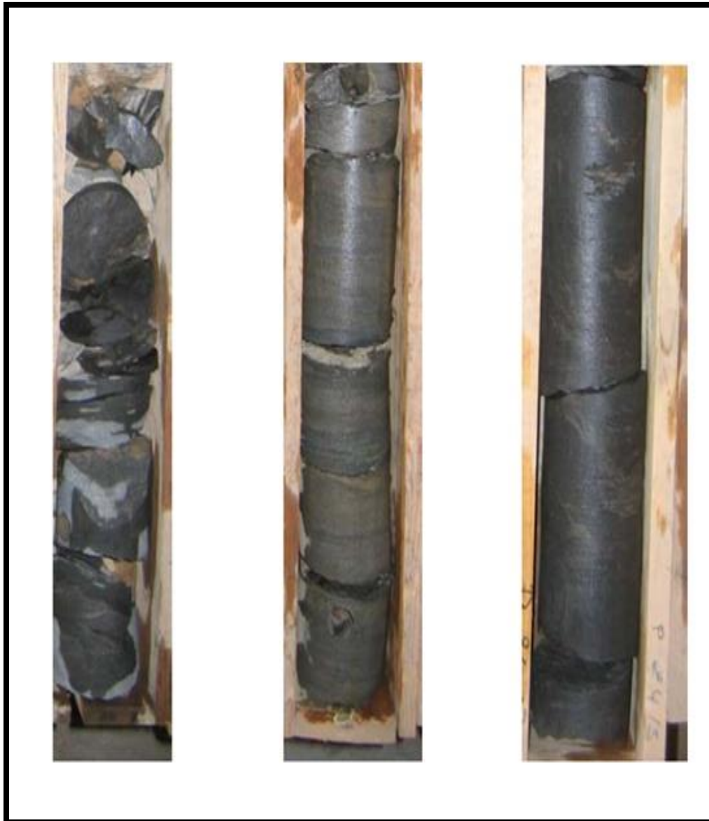
Fig26: Fracture observée sur carotte (documents sonatrach).
