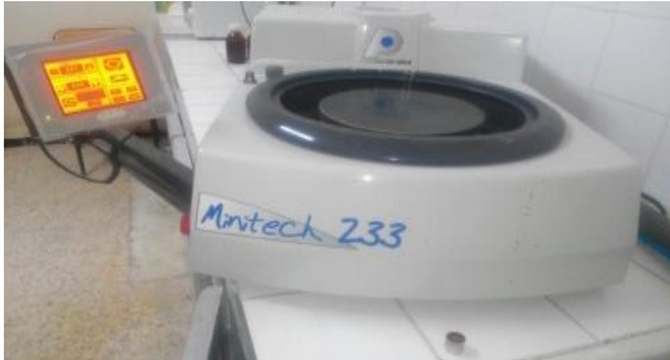
**Figure. III.4.** Polisseuse mécanique (Minitech 233).
