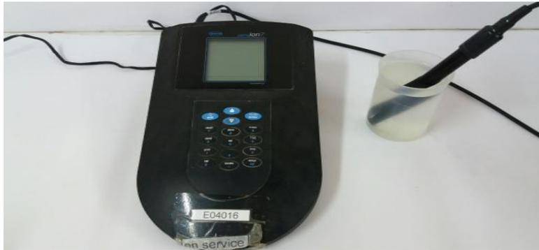
**Figure 16 :** Conductimètre
