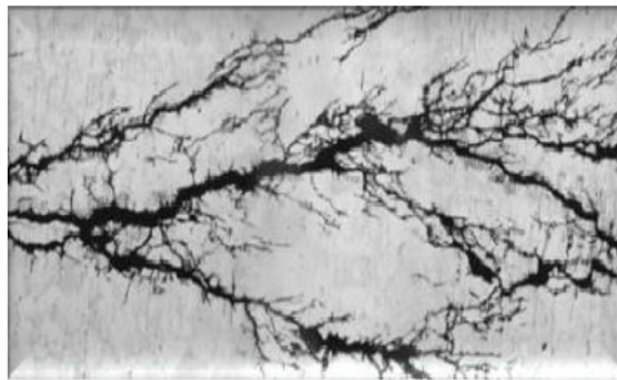
Figure I.5. La corrosion sous contrainte [10].
