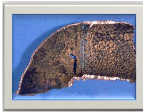
Figure I.3. La corrosion caverneuse [10].
