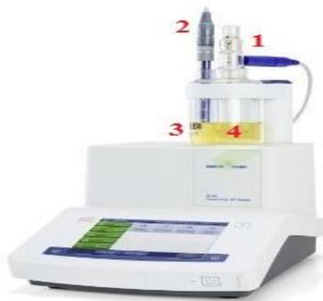
*Figure II. 7 : Appareil de mesure de la teneur en eau (METTLER TOLEDO C20S).*
