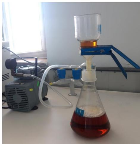
*Figure II. 3 : Dispositif de filtration sous vide de l'huile usagée.*
