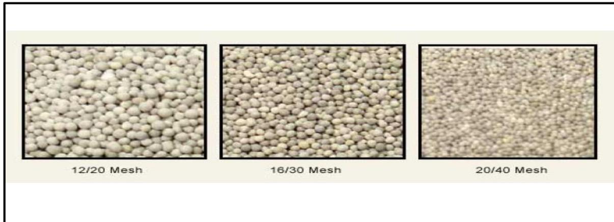
*Figure IV.4 : Différentes granulométries de l'agent de soutènement*
