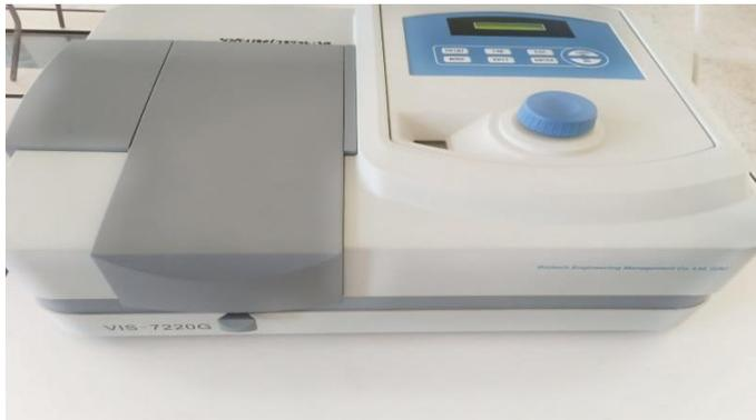
**Figure 3.** Spectrophotomètre pour déterminer la DO
