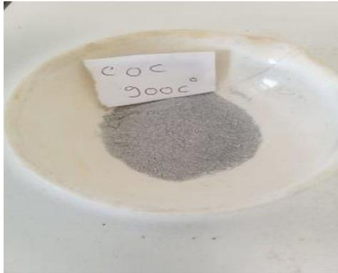
**Figure II.3.** Coquille d'œuf calciné (900°C)
