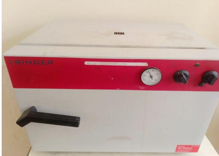
**Figure 1.** Etuve de la marque Binder pour séchage
