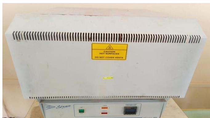
**Figure 8.** Four de la marque Smart utilisé pour calciner les biomatériaux bruts
