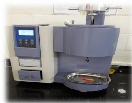
**Figure II.10:** Machine de MFI (fluidimètre)
