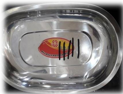
**Figure II.12** : Les extrudât obtenus de l'essai du MFI
