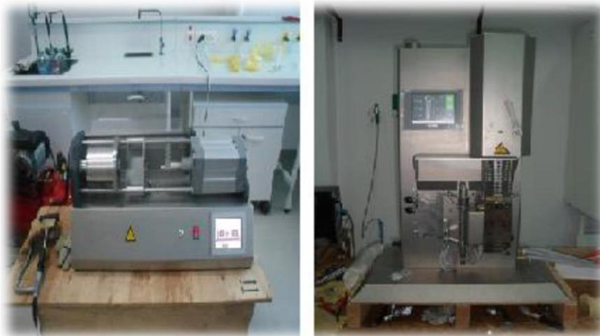
**Figure. II.5. :** Extrudeuse et la presse d'injection
