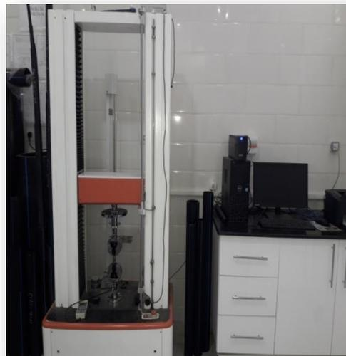
**Figure II.8 :** Machine de traction de type *WDT-W-50B2*
