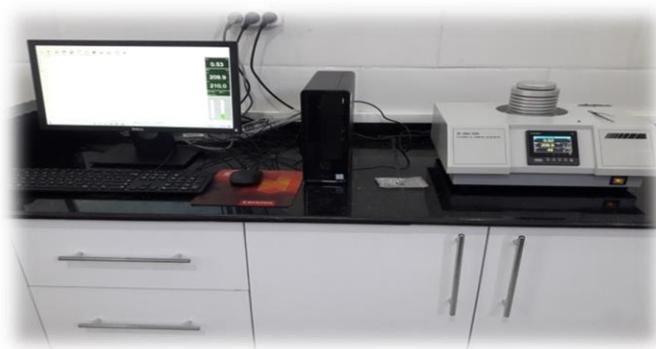
**Figure II.14** : Appareil de DSC
