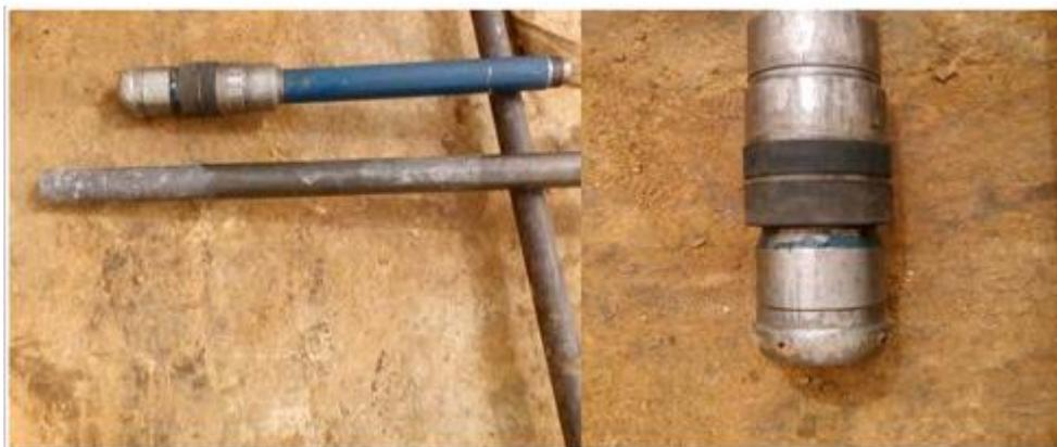
Mécanisme d'étanchéité du piston d'ancrage du Tree Saver (assuré par les joints élastomères)
