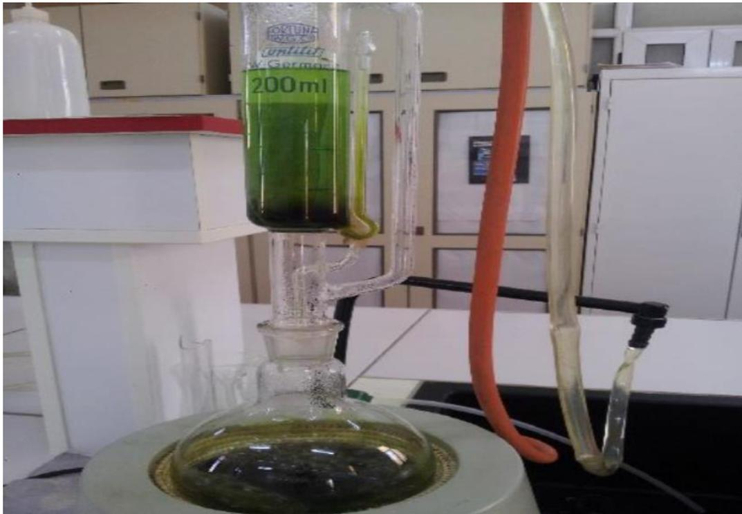
**Fig. 12 :** Extraction d'une plante par soxhlet (Zahaf, 2016)
