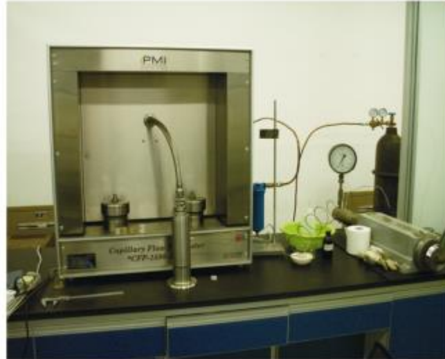
Figure I.13 : Équipement expérimental pour l'analyse de l'influence de la production de sable sur la structure des pores.
