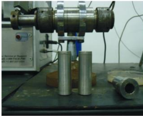
Figure I.9 : Matériel d'expérience pour observer l'influence de la production de sable sur la perméabilité.
