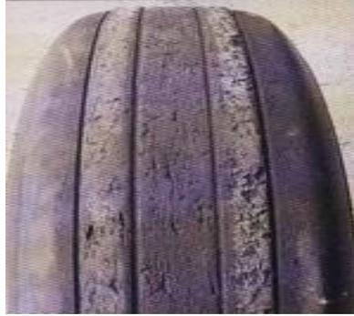
**Figure II.14:** pneu en état défaillant (usure)
