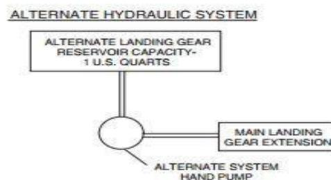
**Figure III.13 :** système hydraulique d'urgence alimente
