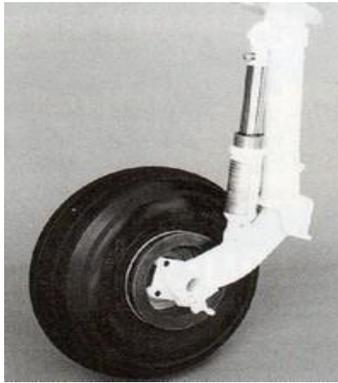
**Figure II.13:** structure de train d'atterrissage
