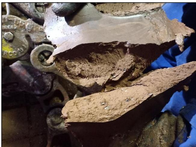
**FigIV.5.** Argile raclée par la garniture de forage
