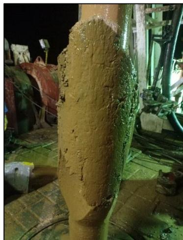
**Fig.IV.6.** Argile raclée par un stabilisateur
