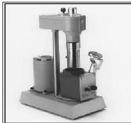
**Fig. II. 3.** Viscosimètre Fann
