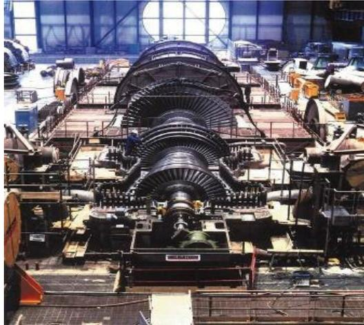
**Fig I-3:** *Turbine à vapeur sans tablier.*
