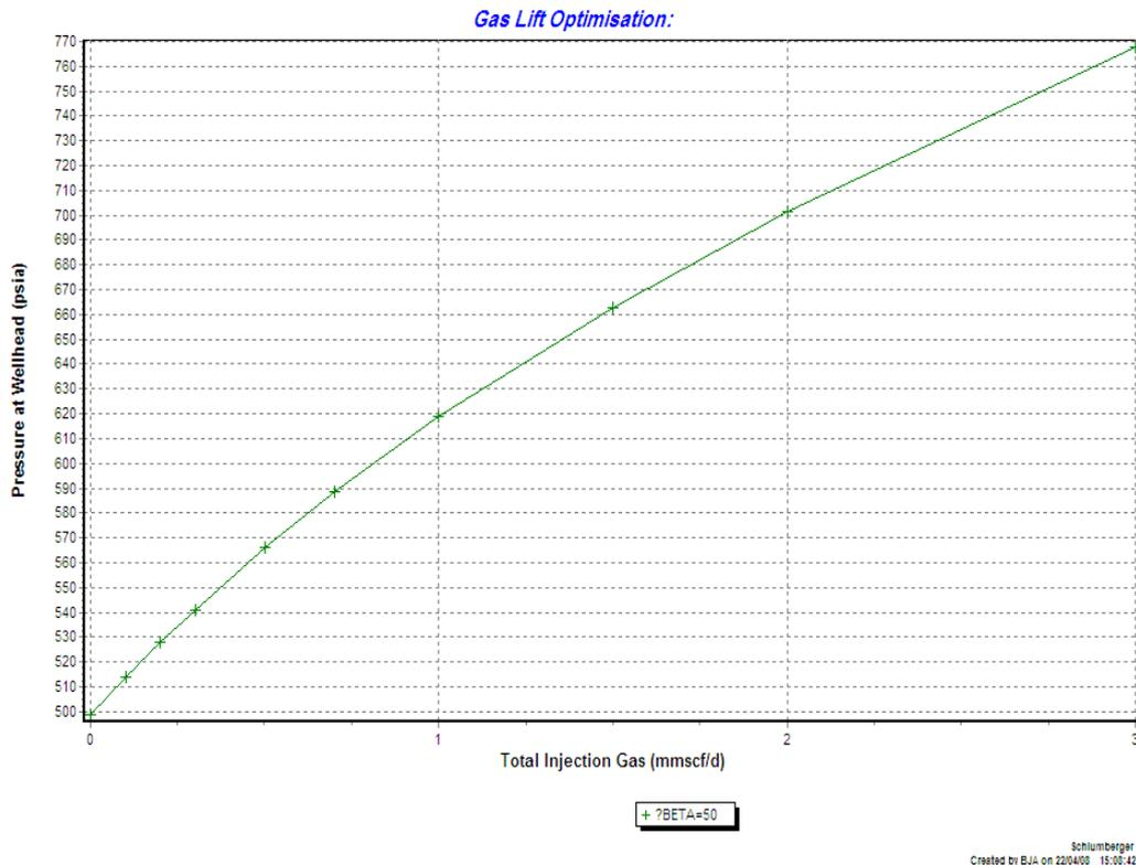
**Fig II.15 Impact du débit d'injection sur la pression en tête de puits.**
