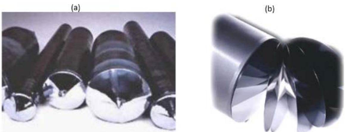
Figure 2. 4 : Barres de silicium a) : Les barres une fois refroidies ;b) : Découpage en wafer
