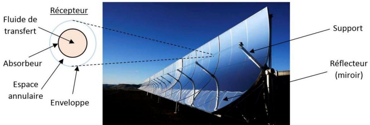
**Figure 3** Description d'un collecteur cylindro-parabolique [42].
