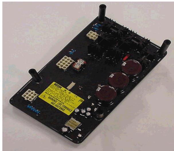
*Figure. I.34 : le régulateur de tension*
