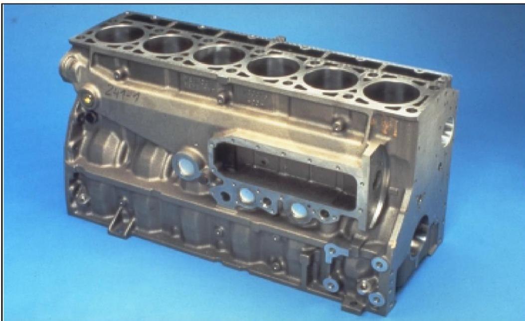
*Figure I.3 : le bloc cylindre*
