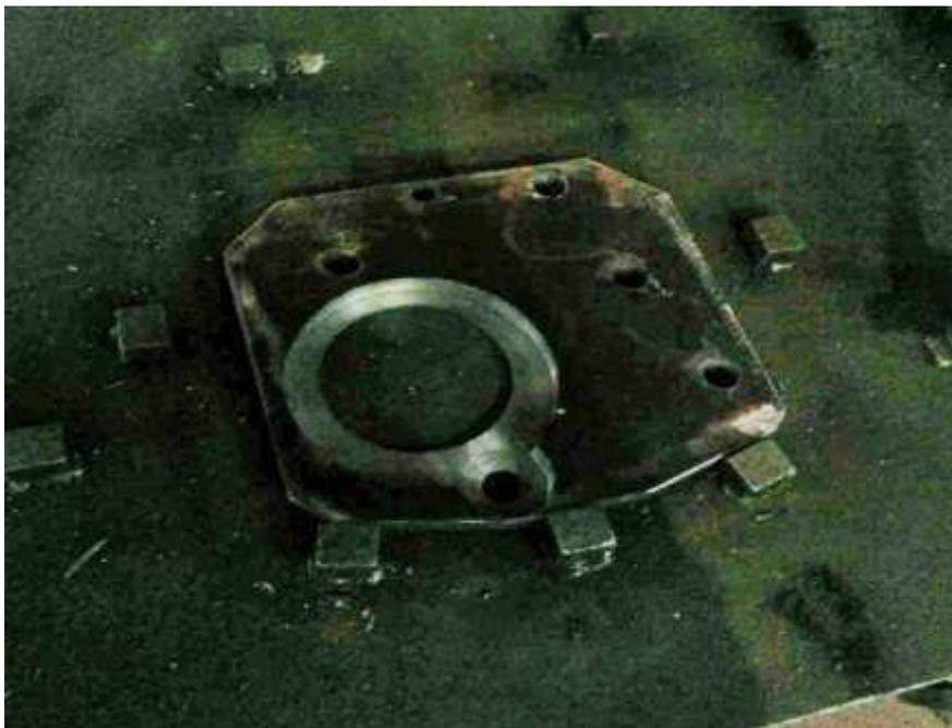
Figure II.4 : ferrure fixation de boîtier
