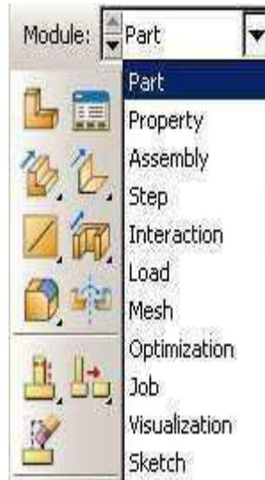
**Figure III.13** : les modules abaqus
