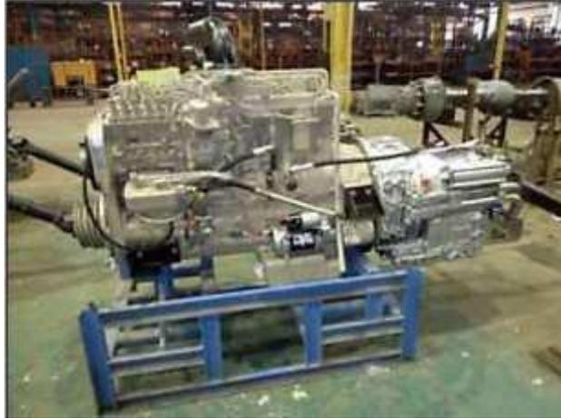
**Figure I-3 :** moteur et boîte de vitesse implantés sur l'autobus 100L6
