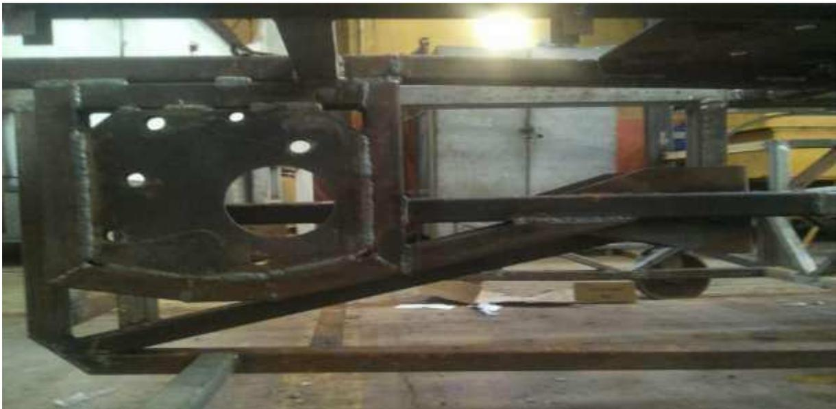
Figure II.9 : le support soudé avec châssis
