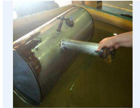
**Figure I.14 :** Contrôle d'un réservoir.
