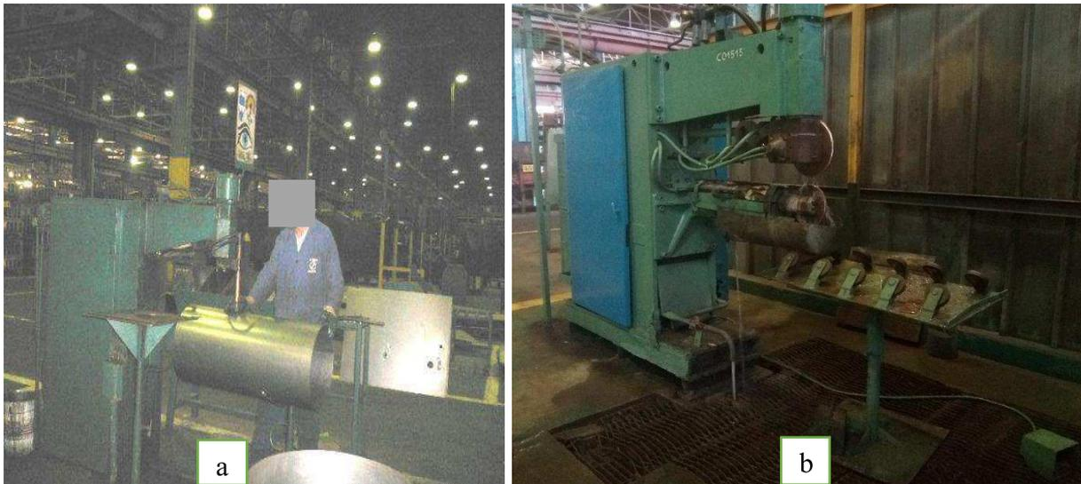
**Figure N°10** : soudeuses par point(a) et par molette(b) pour soudé le Corps de réservoir.
