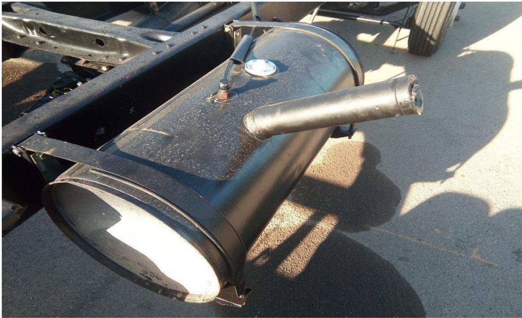
Figure III.2 : Réservoir combustible monté dans le cadre châssis.
