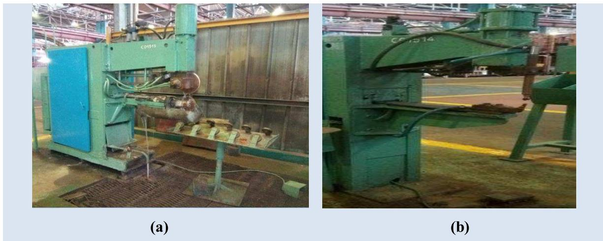
Figure II.10 : soudeuses par résistance, (a) par molette, (b) par point.
