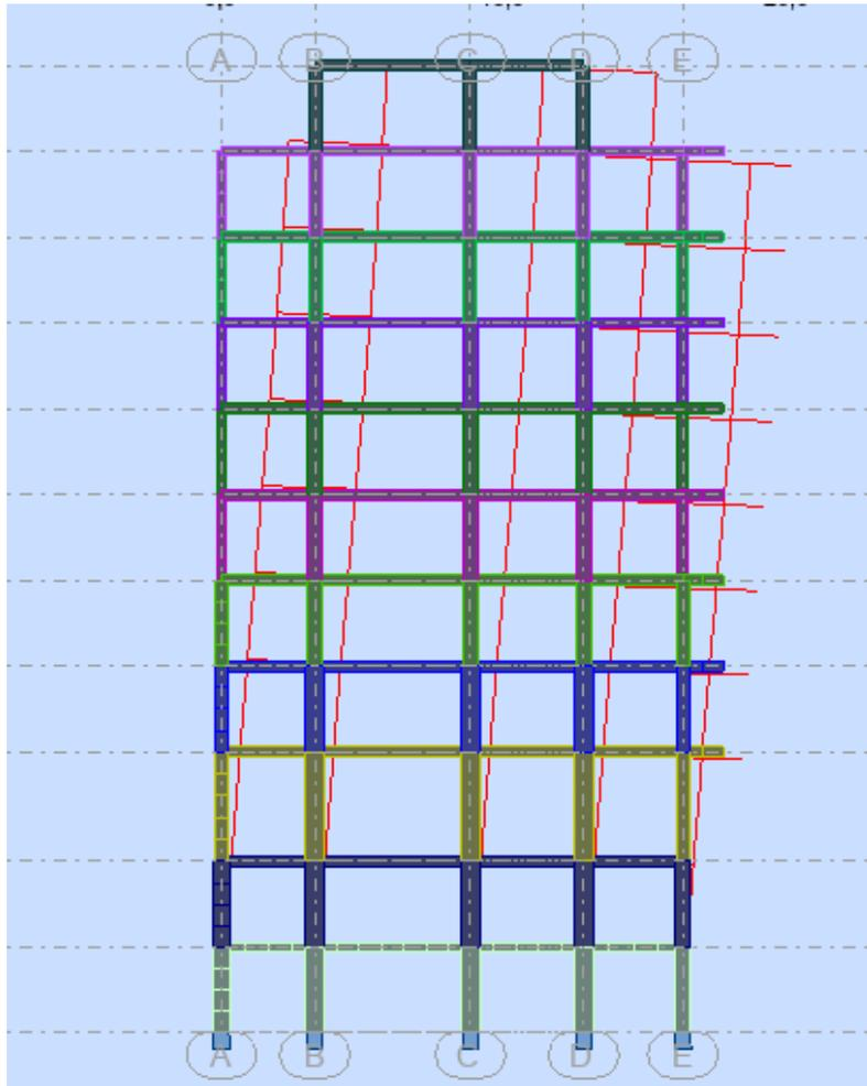
Figure IV.6 : 2<sup>ème</sup> mode translation suivant l'axe Y (En élévation)
