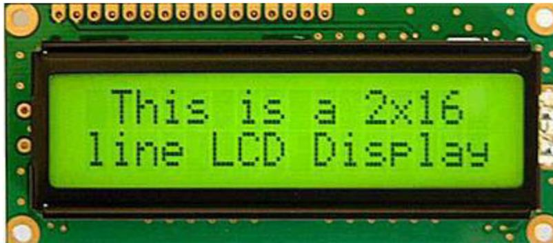
**Figure I.19** Afficheur LCD16x2 [8]
