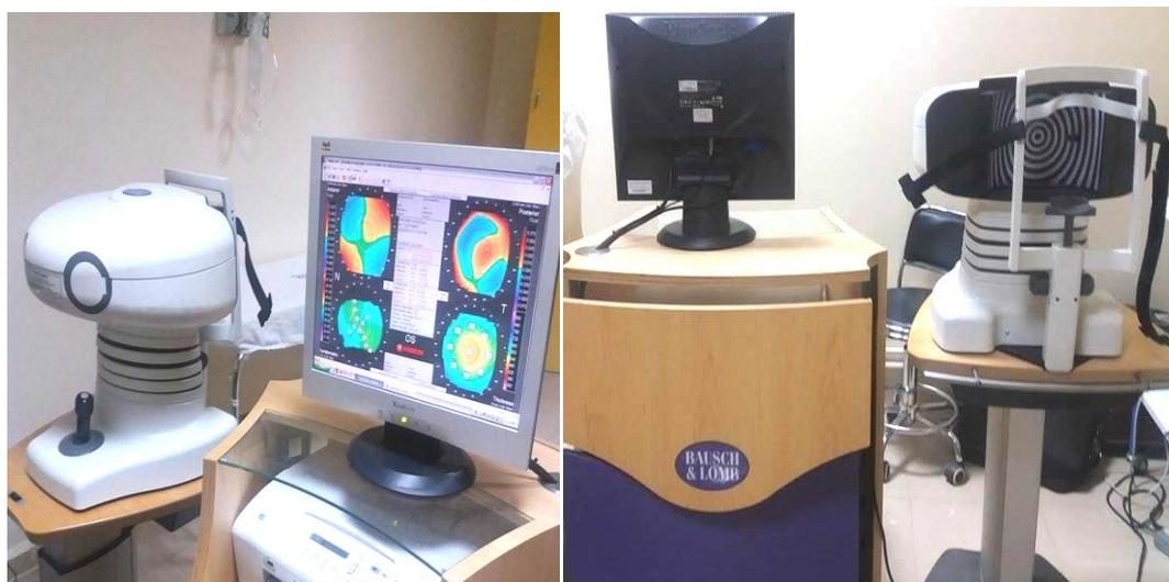
**Figure I.10.**Topographe Orbscan II.
